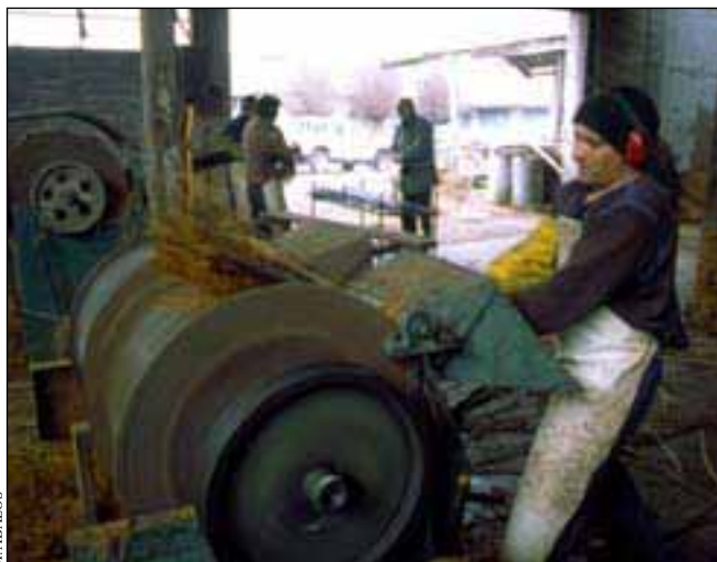
Les gros producteurs pèlent la tige avec une décortiqueuse électrique
