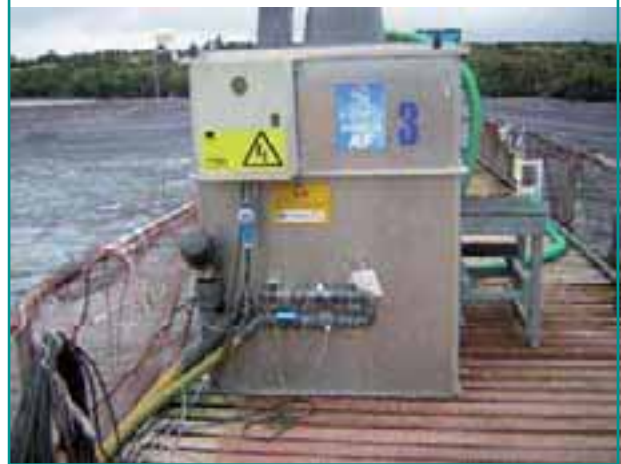
FIGURE 13 Silo d'alimentation automatique muni d'un système de collection des aliments (Chili)
