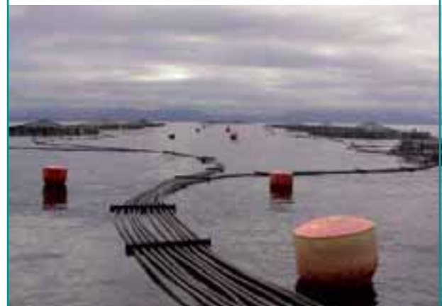
FIGURE 12 Les aliments sont transférés vers les cages individuelles à partir du silo au moyen d'air comprimé
