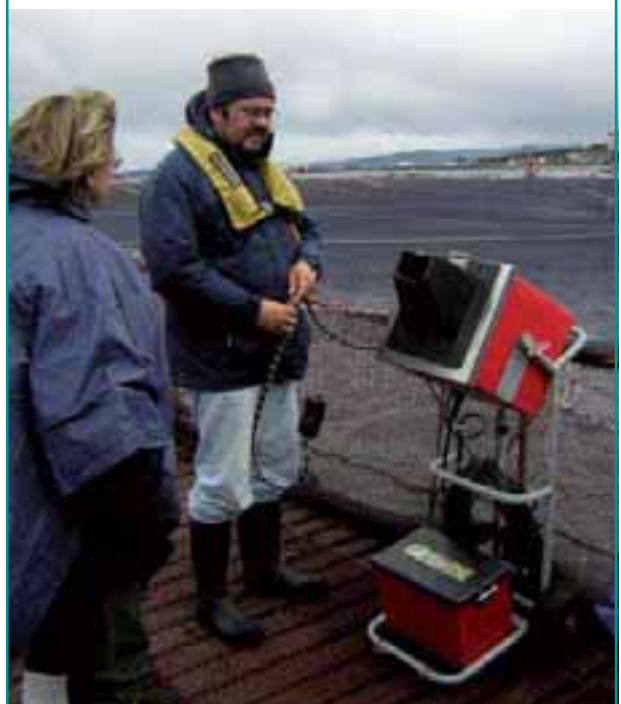
FIGURE 14 Emploi d'une caméra sous-marine pour contrôler l'approvisionnement en aliments (Chili)
