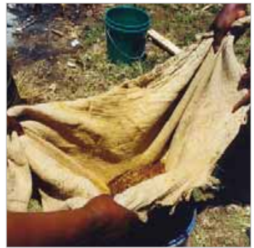
9.9 Filtrage du mélange d'eau et de cire fondue à travers une toile de jute. Tanzanie © NB
