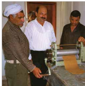
9.11 Utilisation d'un rouleau bosselé pour fabriquer les bases, Iraq © NB
