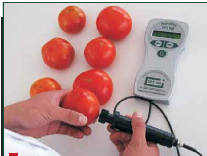
Foto 4.105. Medición de firmeza con Durómetro Durofel. Fuente: Rivero. Laboratorio de Postcosecha INTA EEA Mendoza
