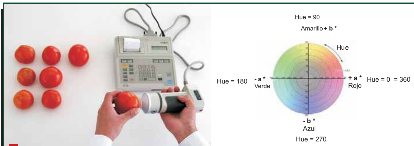
Foto 4.106. Medición de color con colorímetro Minolta CR 300. Fuente: Rivero. Laboratorio de Postcosecha INTA EEA Mendoza
