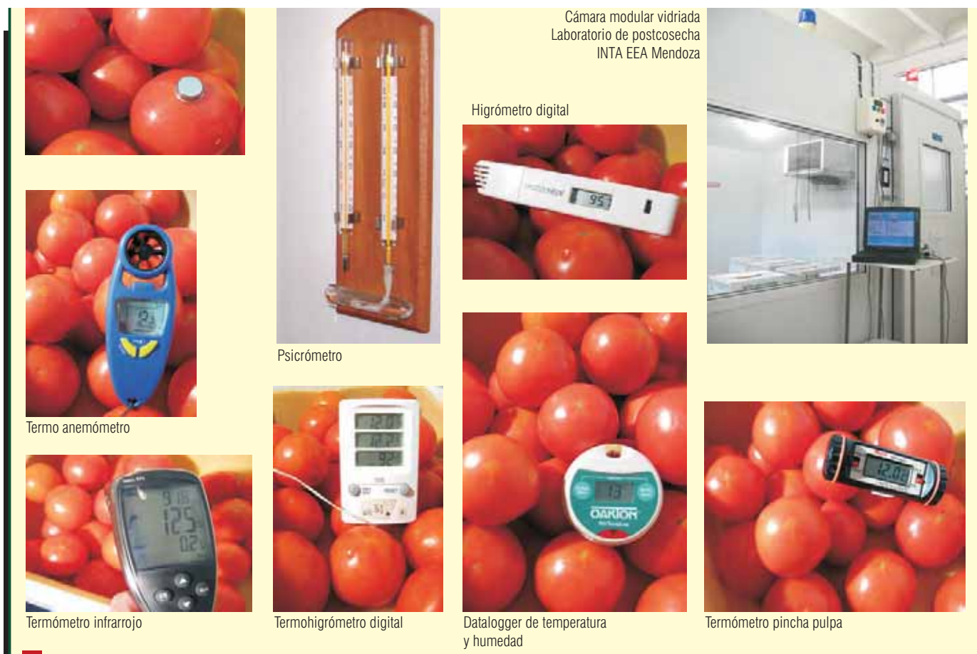
Foto 4.102. Instrumental para monitoreo de condiciones ambientales en túnel de preenfriamiento y cámara frigorífica. Fuente: Rivero. Laboratorio de Postcosecha INTA EEA Mendoza
