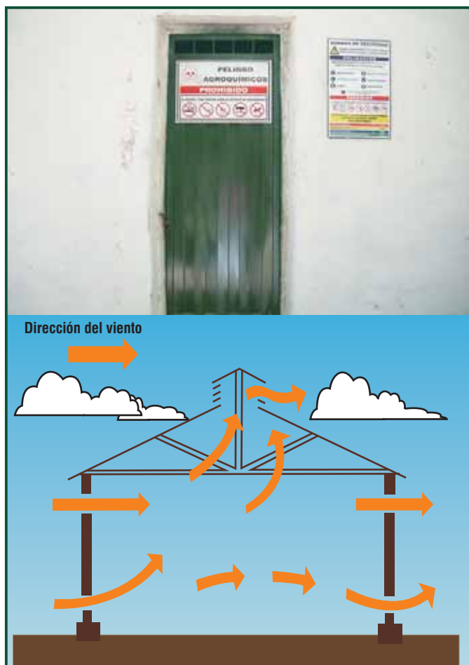
Figura 4.10. (a) Identificación del depósito de agroquímicos, (b) diseño de la ventilación en un depósito de agroquímicos. Fuente: Casafe
