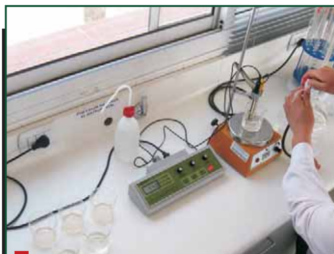
Foto 4.109. Análisis de acidez total titulable con peachímetro digital. Fuente: Rivero. Laboratorio de Postcosecha INTA EEA Mendoza
