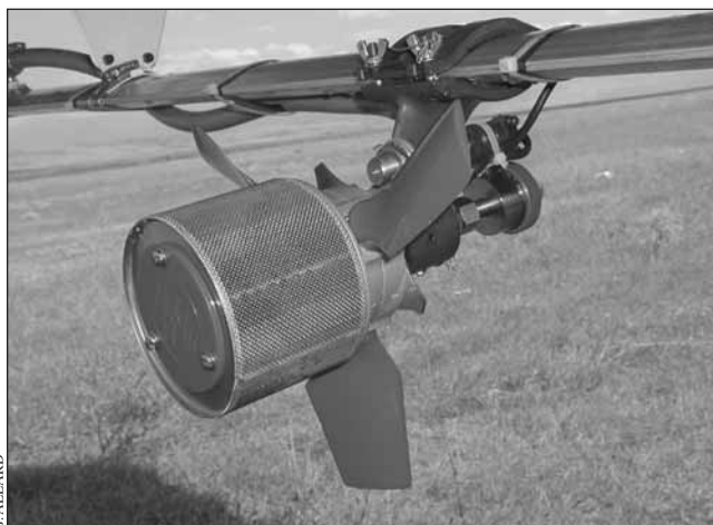
Des pulvérisateurs centrifuges modernes ont été installés sur des aéronefs existants pour obtenir des gouttelettes de la dimension nécessaire aux pulvérisations à faible volume du Btk et des régulateurs de la croissance des insectes
