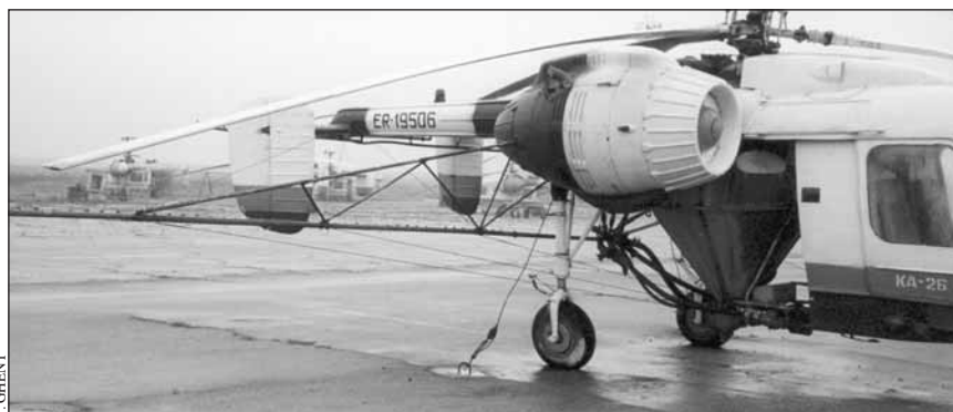
Aéronef local pour le traitement des cultures agricoles (hélicoptère KA-26) doté d'une lance d'arrosage vétuste, inadaptée aux opérations forestières de pulvérisation de biopesticides à faible volume
