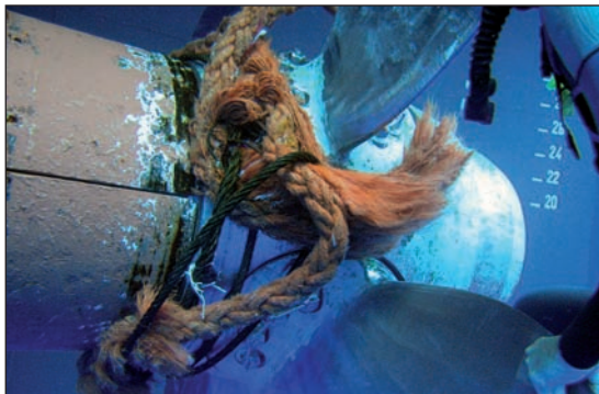
FIGURA 8 Los efectos de los ALDFG en las hélices
