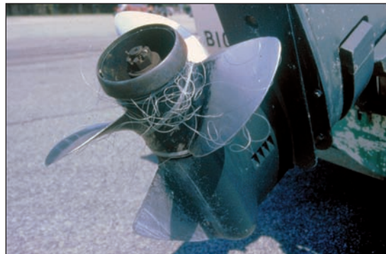
FIGURA 8 Los efectos de los ALDFG en las hélices
