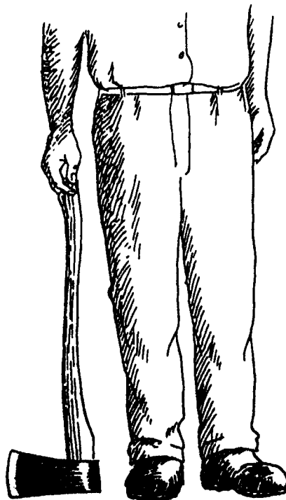
Figura 23. Diseño ergonómico de un mango para hacha. La forma de S ayuda a absorber los golpes, la forma oval calza con la empuñadura de la mano, el levantamiento evita que se resbale y el largo es apropiado para ese usuario en particular.
