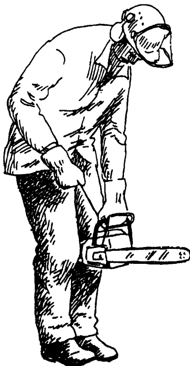
Figura 40b. Como encender la motosierra sosteniéndola entre las rodillas.
