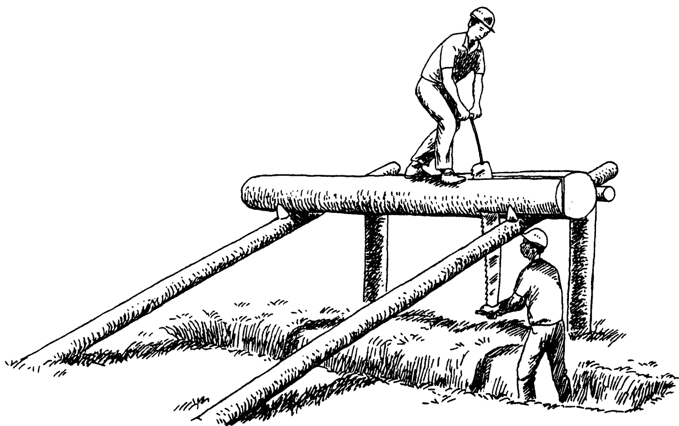
Figura 49. Aserrado en foso.
