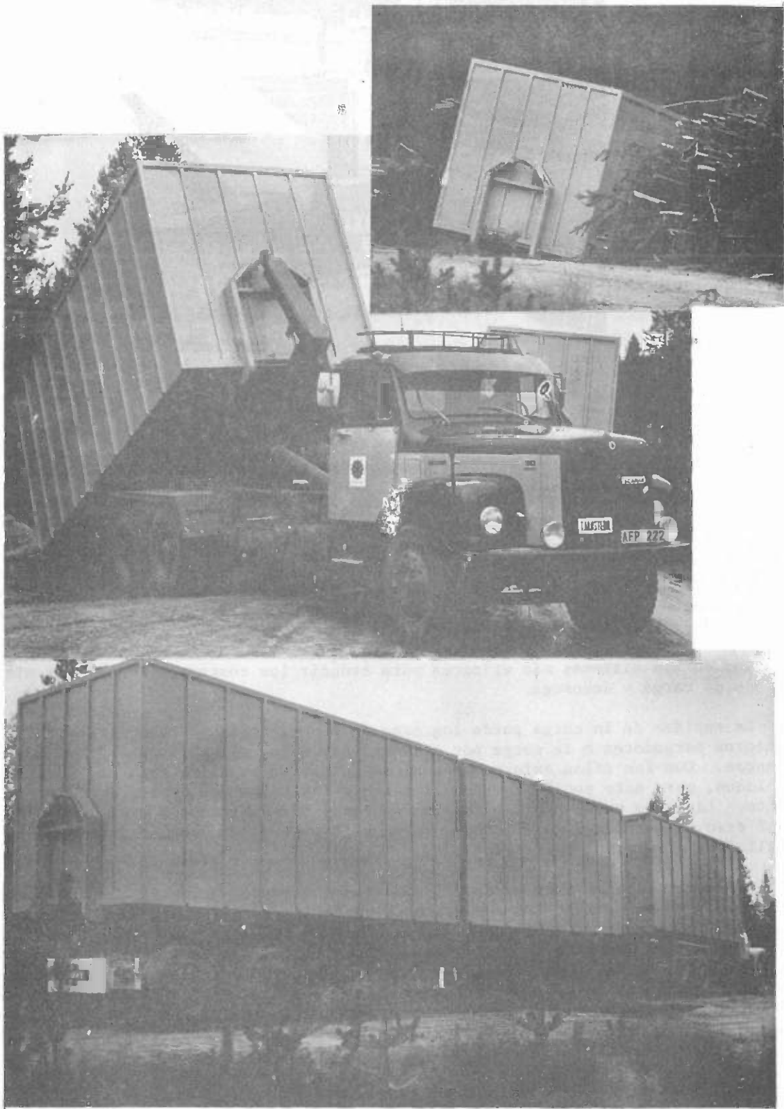
Fig. 46. Ejemplo de un sistema de contenedores (HIAB-FOCO); cada contenedor tiene en este caso un volumen de unos 38 \text{ m}^3 .
