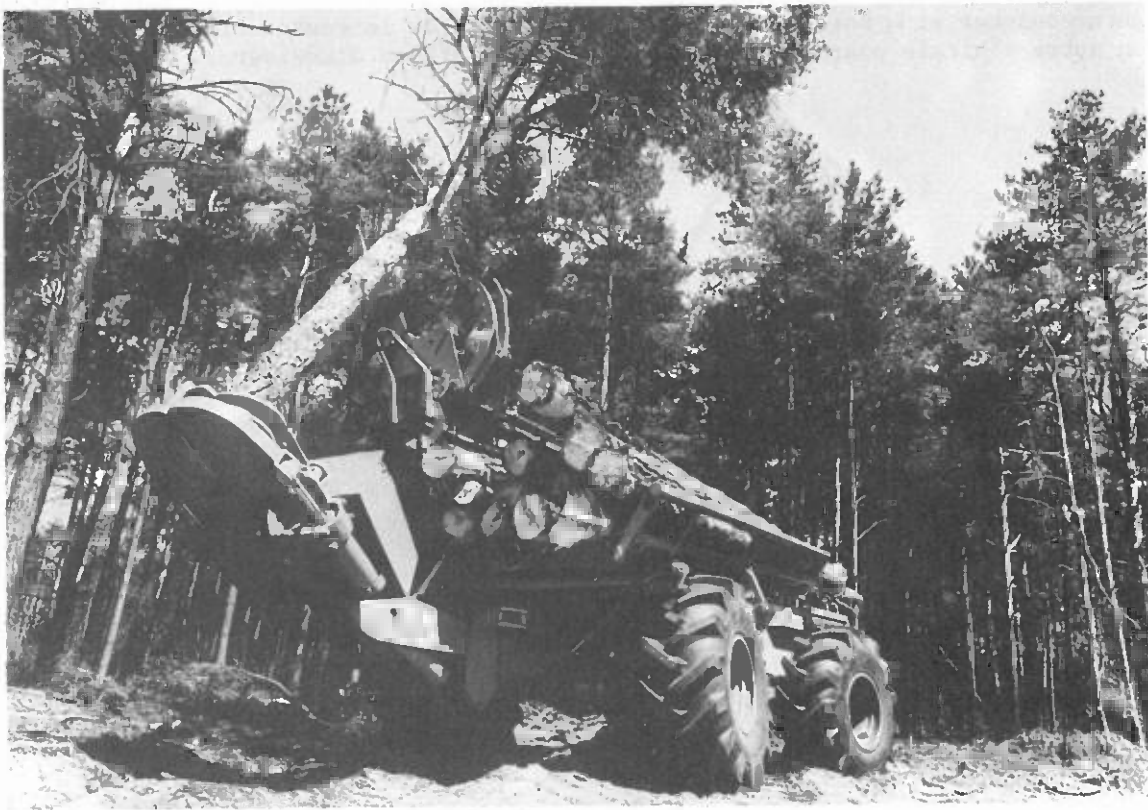
Abatteuse-ébrancheuse-forwarder chargeant les arbres abattus sur un chariot sur rail
