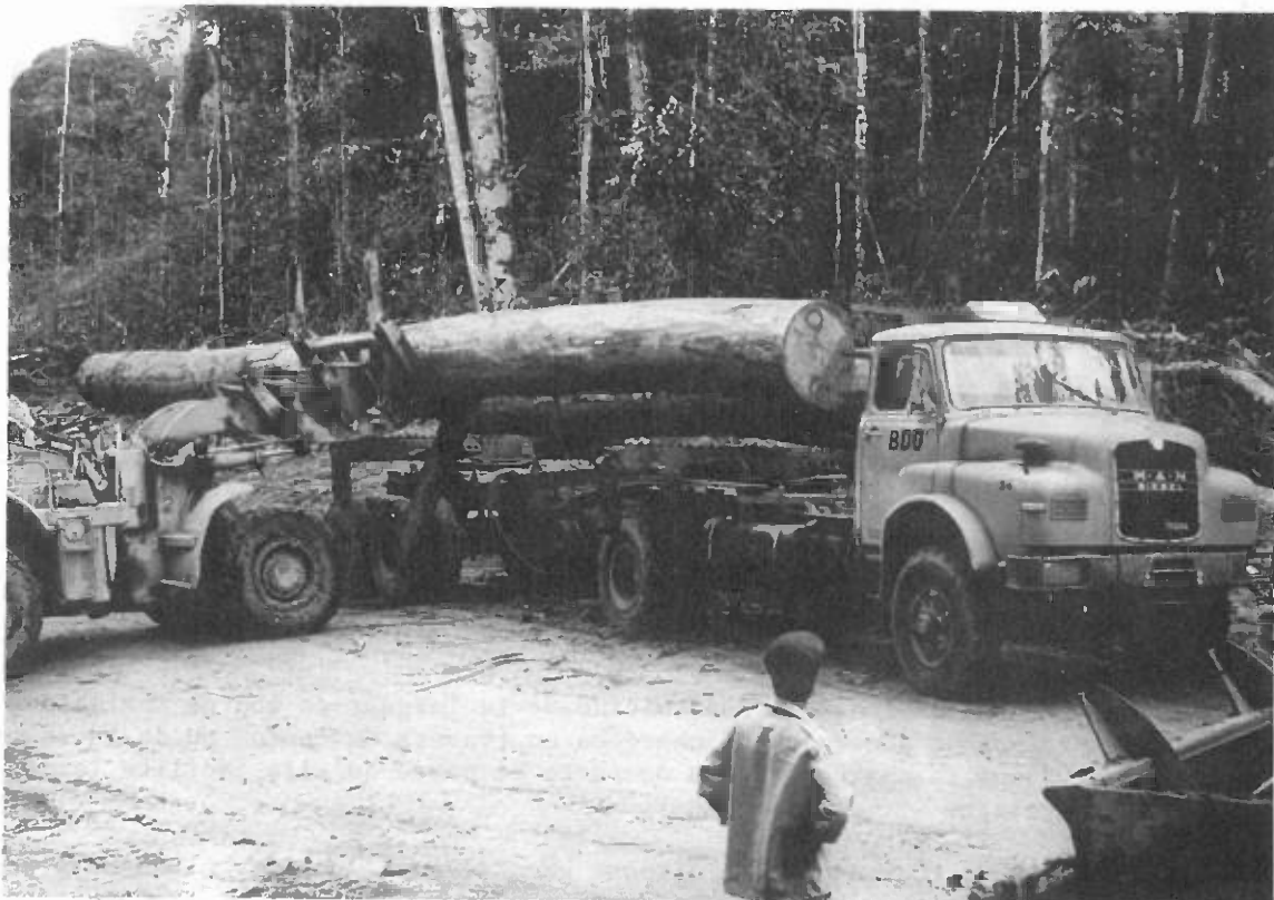
Chargement du grumier avec chargeur frontal sur pneu
