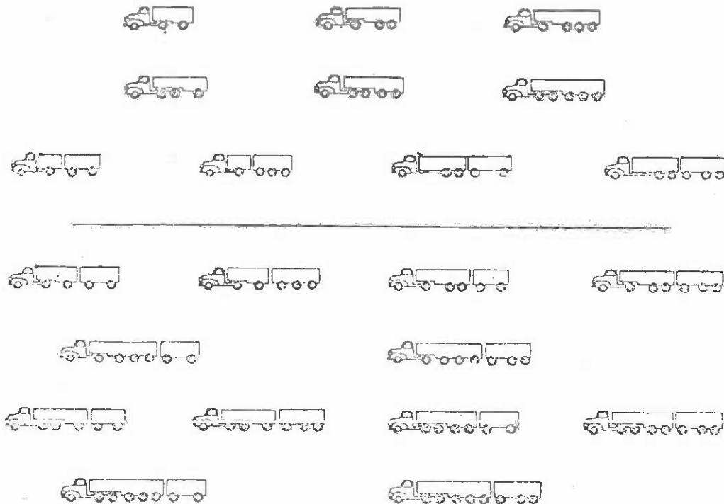
Figure 10 Exemples typiques d'ensembles tracteur-remorque
