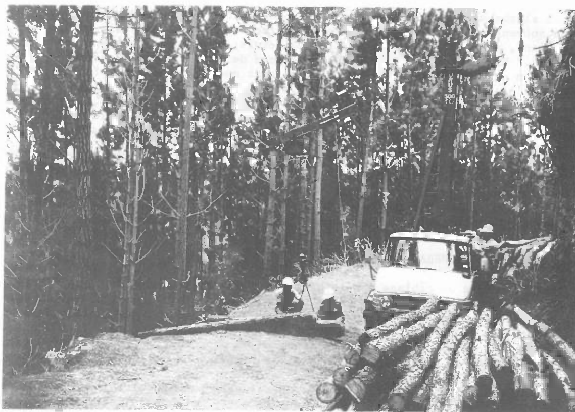
Équipement mobile de câble-grue pour l'extraction des grumes dans les opérations d'éclaircie
