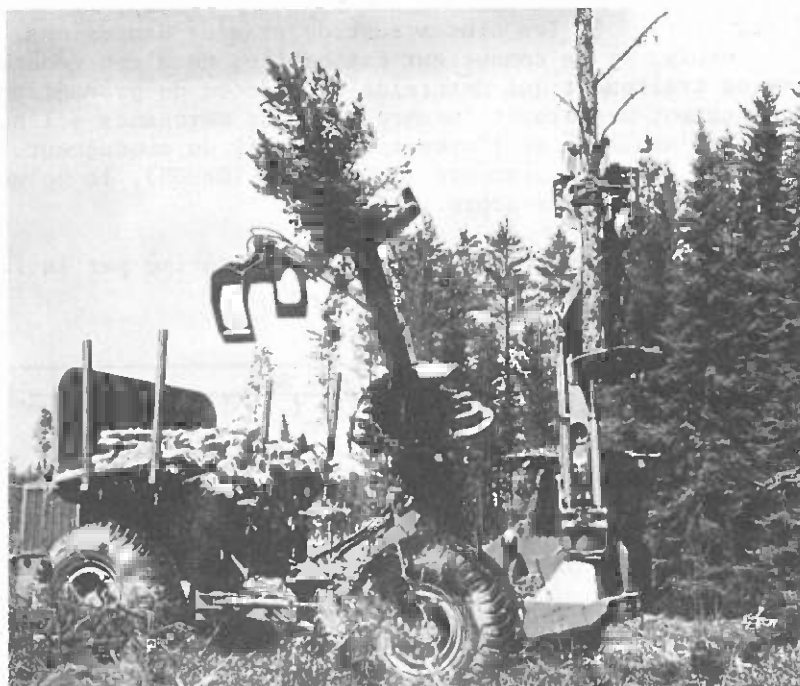
Machine d'exploitation polyvalente traitant les arbres à la souche et les transportant en bord de route
