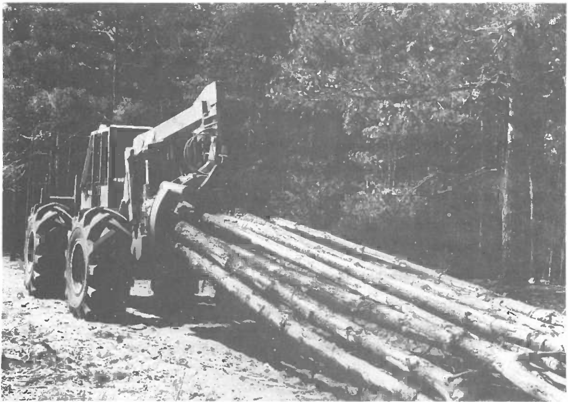
Tractor forestal de garra extrayendo una carga de trozas.
