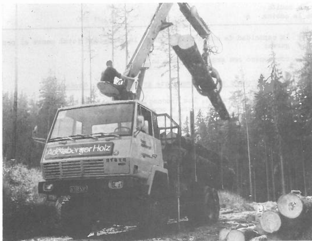
Grúa cargadora accionada hidráulicamente montada sobre camión.
