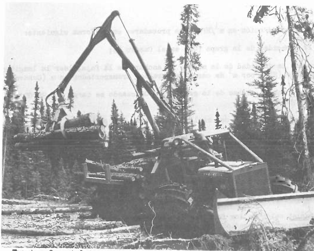
Tractor forestal transportador articulado para madera corta.
