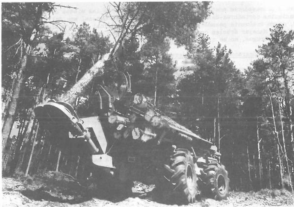
Cortadora-desramadora-transportadora colocando un árbol cortado sobre el carro desramador.
