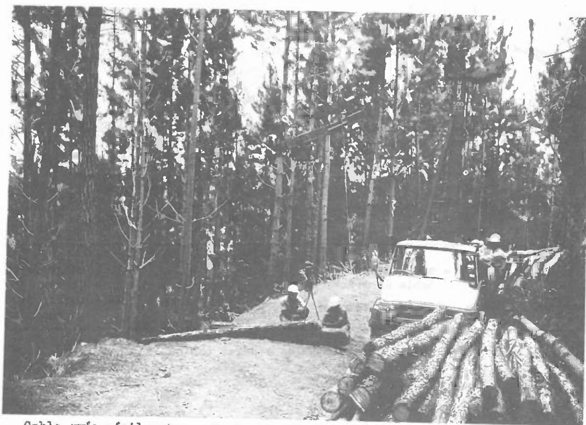
Cable grúa móvil extrayendo trozas en operaciones de aclareo.
