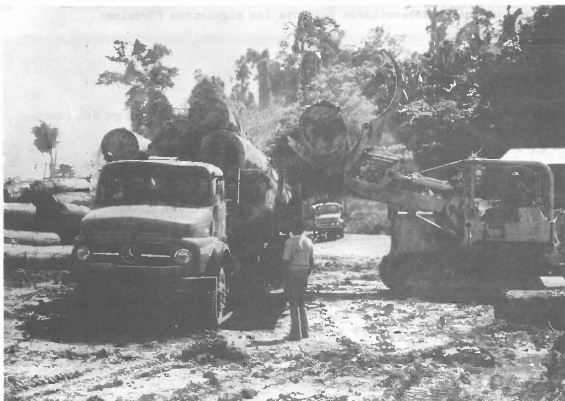
Cargador frontal montado sobre orugas descargando trozas en el cargadero final.
