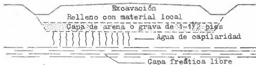
Figura 3 - Capa de aislamiento entre la capa freática del subsuelo y una explanación que contiene suelo de gran capilaridad (18).
