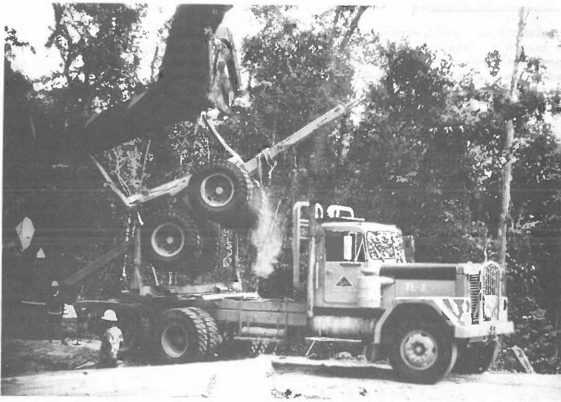
Descarga de semi-remolque con ejes en tandem para empalmarlo con camión tractor para el transporte de trozas.
