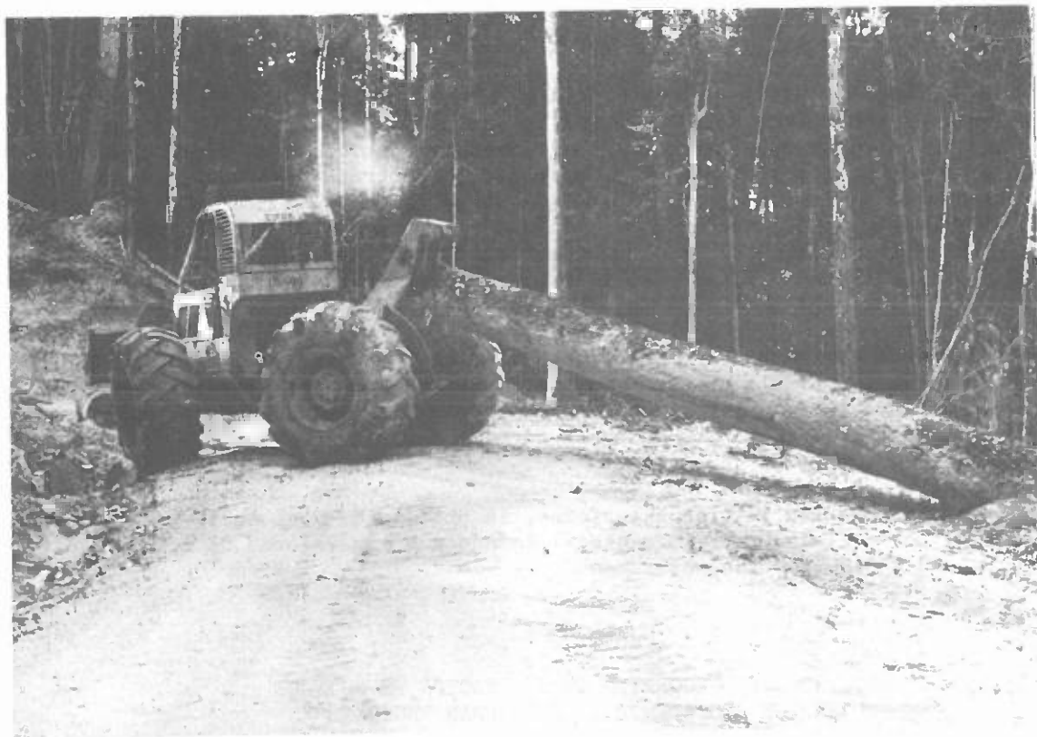
Extracción de madera a la carretera mediante tractor forestal arrastrador.
