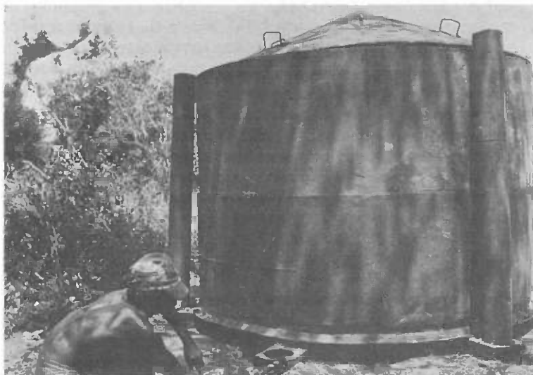
Allumage d'un four à carboniser
