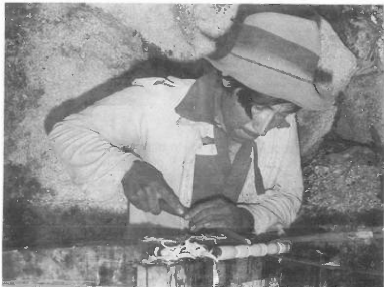
Tournage d'un pied de chaise dans un atelier rural communautaire
