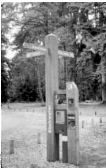
Un parquímetro combinado con un punto de información, hecho con madera maciza para no desentonar con el bosque y darle resistencia
