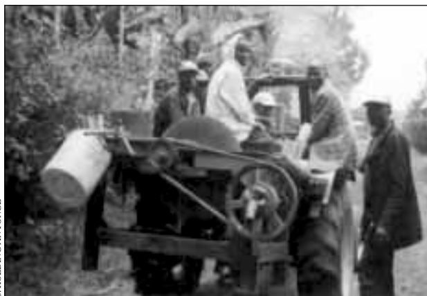
Sierra circular montada sobre un tractor, Kenya
