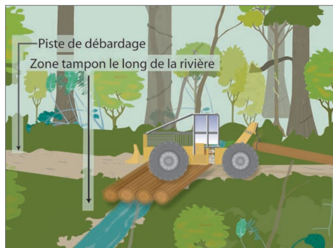
Figure 32. Traversée provisoire d'un cours d'eau par passage en rondins
