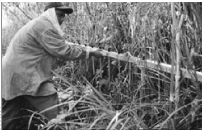
Les membres de la VMPCI ont reçu une formation pour mesurer les indicateurs sélectionnés; ils ont notamment appris à mesurer l'érosion en nappe, avec une barre spéciale.
