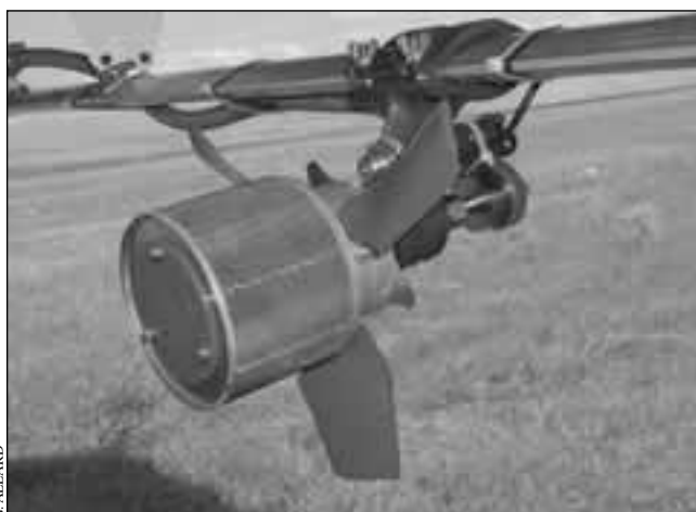
Sistemas modernos de atomizador rotativo se adaptaron a los aparatos existentes para obtener las gotitas pequeñas necesarias para pulverizar bajos volúmenes de Btk y de reguladores del crecimiento de los insectos
