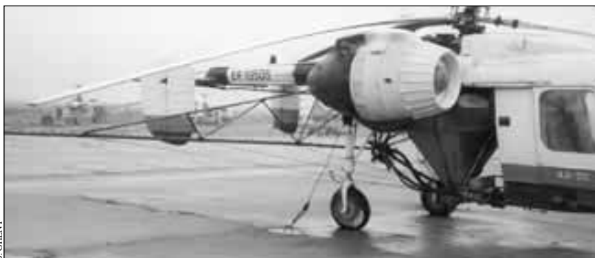
Aparato local de pulverización agrícola (helicóptero KA-26) con un viejo sistema hidráulico de boquilla pulverizadora, inadecuado para rociar bosques con bajos volúmenes de bioplaguicidas
