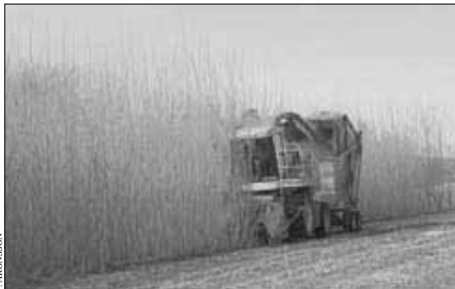
Las plantaciones bajas de sauce de corta rotación se recolectan cada tres a cinco años, en invierno cuando el suelo está helado, utilizando máquinas de diseño especial
