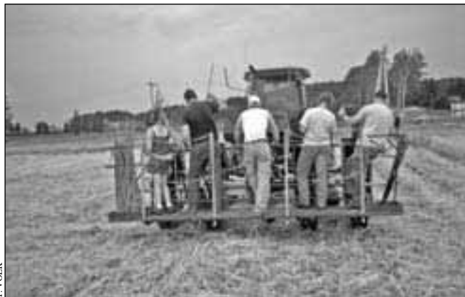
Plantación de sauce sobre un cultivo de cobertura invernal de centeno utilizando un tractor equipado con plantadora mecánica
