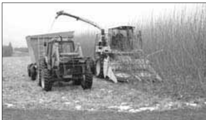
Prueba de un sistema de recolección del sauce utilizando una cosechadora mecánica de forraje con un cabezal cortador modificado
