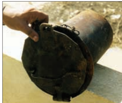
clapet de retenue utilisé en Égypte pour fermer les canalisations de drainage et contrôler les flux de sortie.
