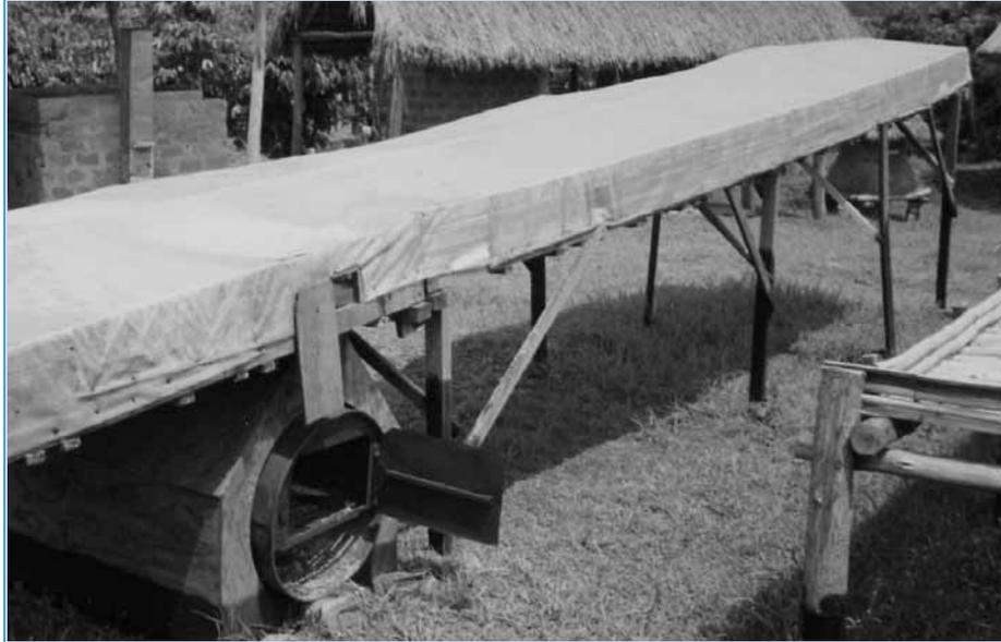
FIGURA 6: Un secador combinado, a energía solar y de combustible (foto del autor)
