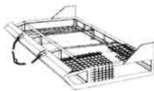
Draga per molluschi bivalvi, tipo industriale; peso (vuota) kg 500 - 1 000
