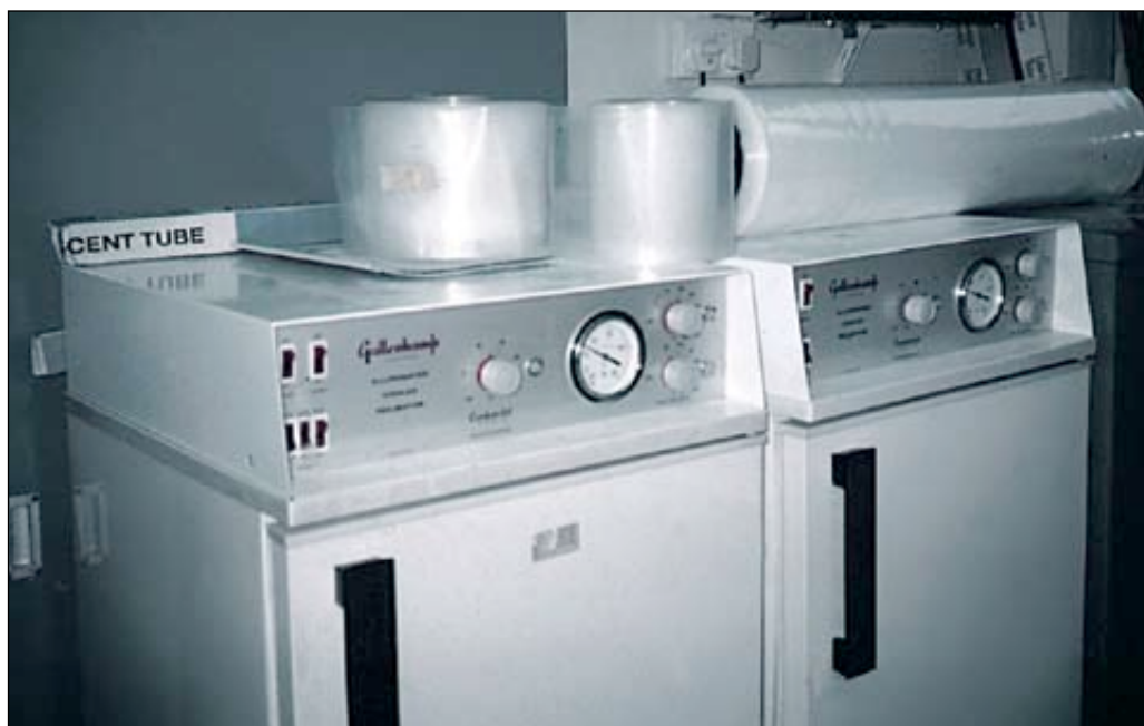
图15: 用于保存少量单细胞藻类的控光控温培养箱。
