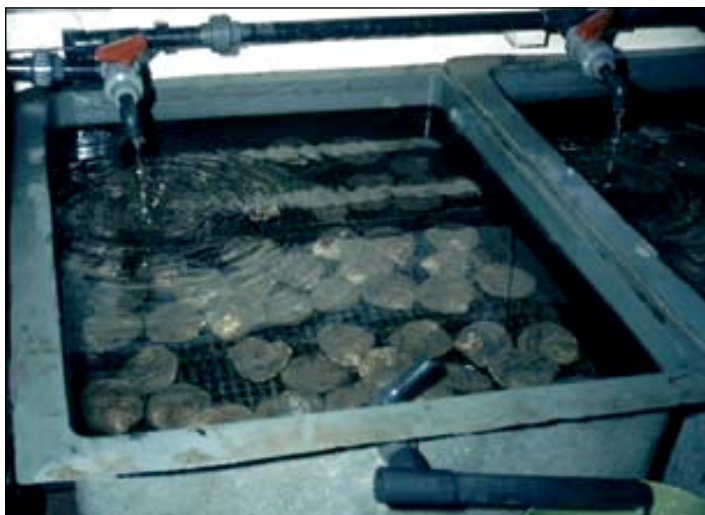
图37: 蓄养池体积120升, 放养55只牡蛎, 平均活体重为80克。在此密度的蓄养池中, 添加饵料的海水的最小流速应达到1375毫升/分。
