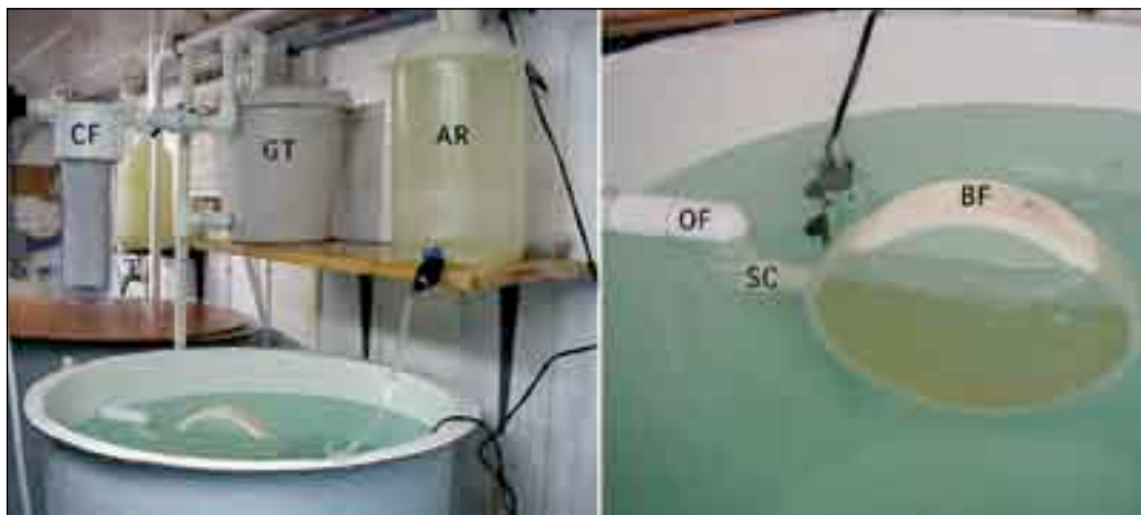
图64: 实验性流水培育槽以及附属装置的详细说明 (BF)滤鼓, (OF)与滤鼓相连的排水管, (CF)桶式过滤器, (GT)高位水槽, 给培养槽提供稳定的过滤海水, (AR)微藻贮罐, 为幼虫提供微藻饵料。“滤鼓”由直径20厘米的PVC管制成, 两面用胶粘剂固定上筛网, 网目为60微米。在滤鼓上焊接一根粗细相应的PVC管, 与培养槽相连。(SC)与滤鼓和排水管的活丝接头, 并与排水管形成90°夹角。这样可以向上转动滤鼓, 使得滤鼓离开水面便于清洗和更换。
