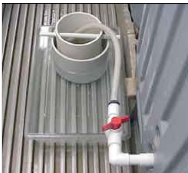
图56: 收集D形幼虫用的筛网。孔径60微米筛网悬于孔径40微米的筛网上,40微米筛网浸在装有交换海水的浅水槽中。该装置可按幼虫大小分规格收集,同时确保幼虫不会暴露在空气中。
