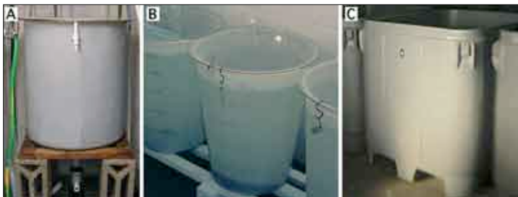
图52: 胚胎(和幼虫)培育容器。(A) 200升下排水陡壁圆柱形玻璃钢桶; (B) 125升聚乙烯平底桶; (C) 1000升隔热聚乙烯圆角方形桶。
