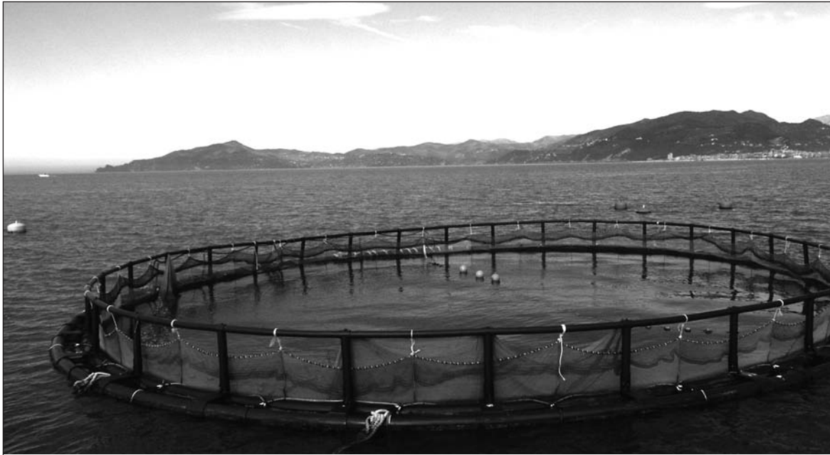
illustration 6 Cage circulaire modèle HDPE, Lavagna.
