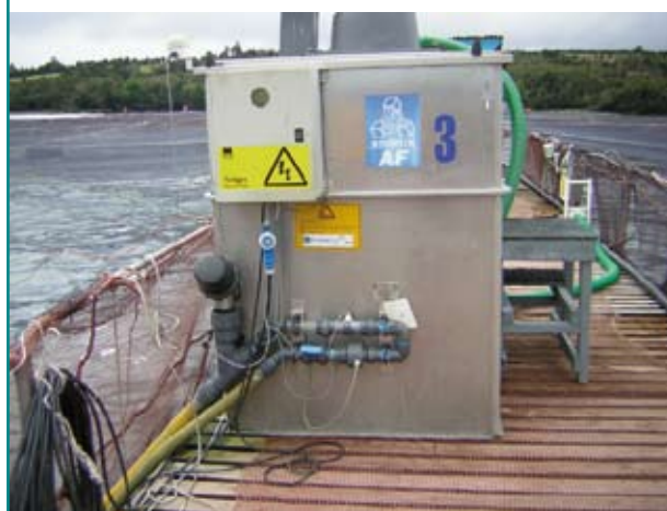
FIGURA 13 Silo de alimentación automática con sistema de recolección de alimento (Chile)
