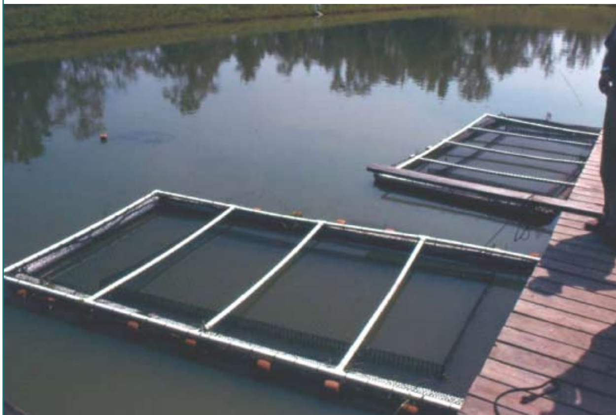
FIGURA 3 Jaula en agua dulce de 7 m 3 para la acuicultura del bagre del canal
