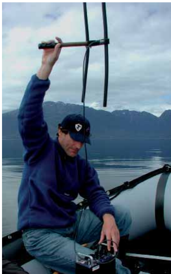
РИСУНОК 7.10 Ручная антенна Adcock H
