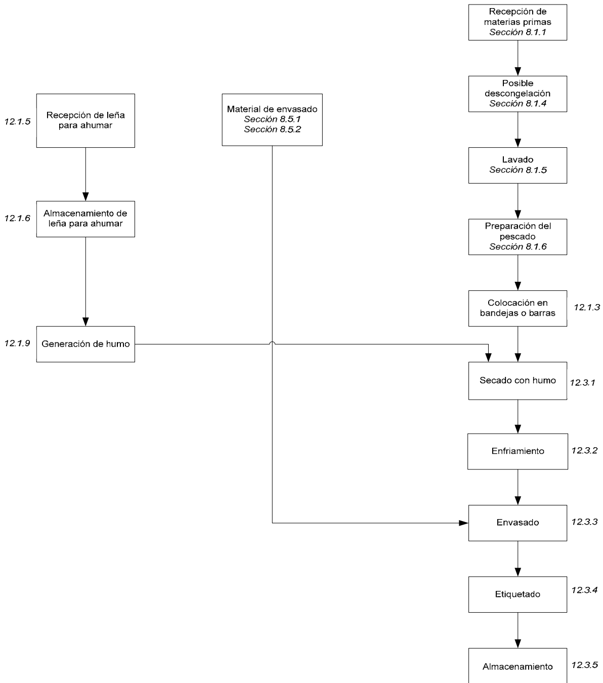
Figure 12.2 Ejemplo de diagrama de flujo de una cadena de preparación de pescado ahumado en seco
