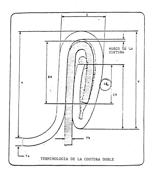
Mediciones ópticas: Las longitudes del solapado, del cuerpo de la lata y del gancho de la tapa son directamente visibles en una sección transversal del sertido. Las otras dimensiones del sertido doble deberán medirse mediante un micrómetro. (Las arrugas y otros defectos visibles solamente podrán observarse separando el gancho de la tapa). Los segmentos del sertido doble que hayan de examinarse deberán, por ejemplo, tomarse en dos o más puntos del mismo sertido doble.
