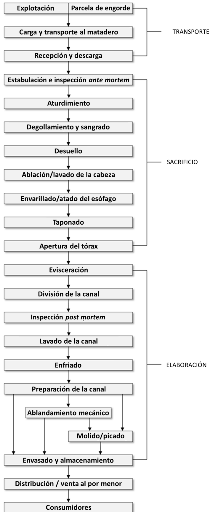
Diagrama 1: Ejemplo de diagrama de flujo de la producción primaria y la elaboración de carne de bovino cruda
