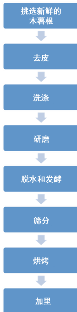
图 1：加里生产流程图
