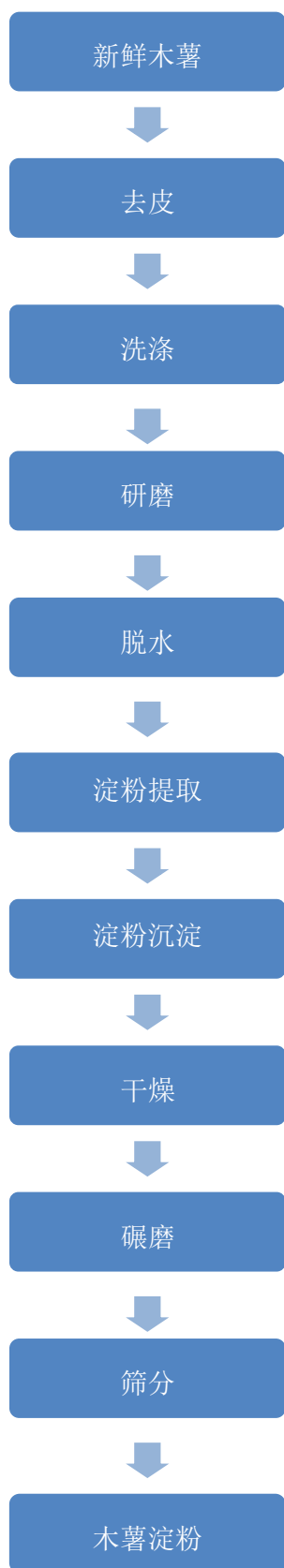
图 7：木薯淀粉的制备流程图
