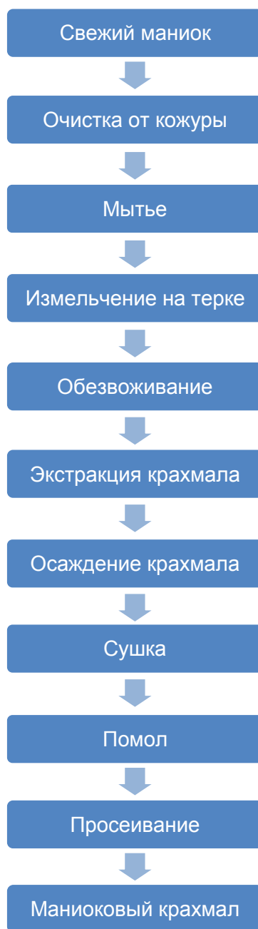
Рис. 7 Технологическая схема производства маниокового крахмала
