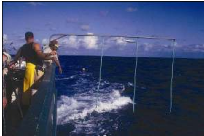
Figura 12. Cortina de agua desplegada por la banda para su uso en el virado del palangre
