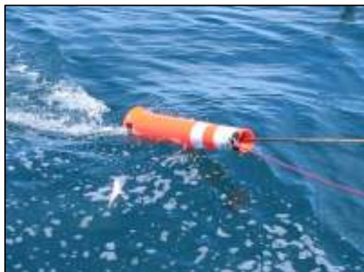
Figura 14. Conos de tráfico utilizados para reducir los contactos de aves con el cable de arrastre. Detalle de un cono instalado durante la maniobra de arrastre y virado del arte (Foto Diego González Zevallos).
