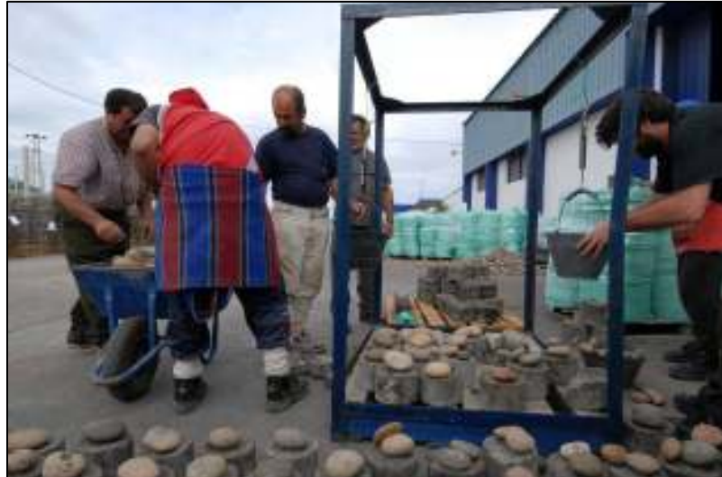
Figura 4. Preparado experimental de lastres de material y piedras envueltas en red (foto Graham Robertson).
