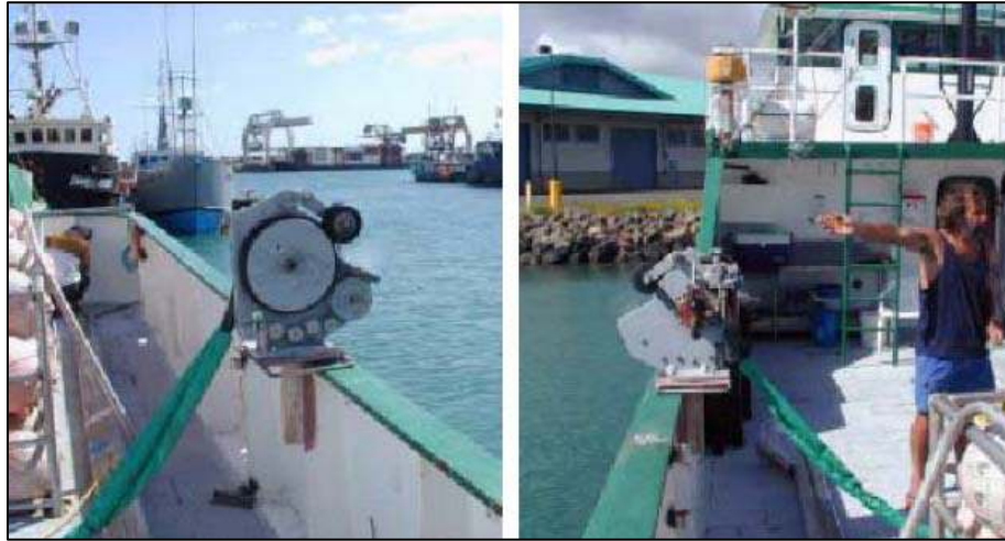
Figura 7. Configuración de la banda en un palangrero con máquina de calado.
