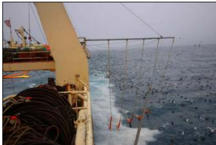
Figura 19. Configuración del método de vara y boyas en línea (tomado de Melvin et al. 2004)
