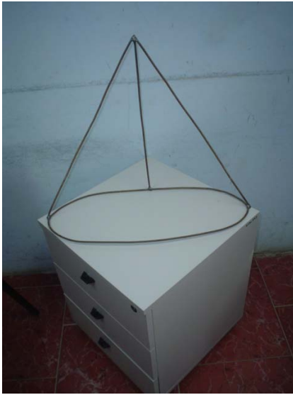
Figura 2. Aditamento de escape de peces construido con alambrón
