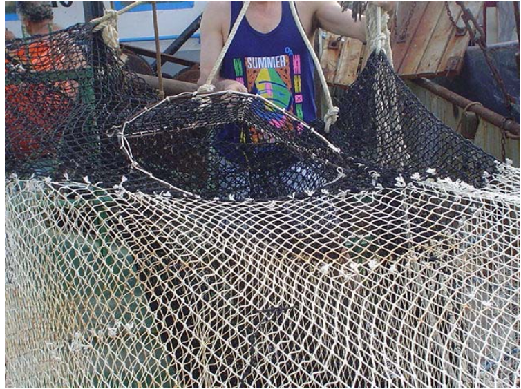
Figura 3. Ubicación del aditamento en la tapa superior de la red.
