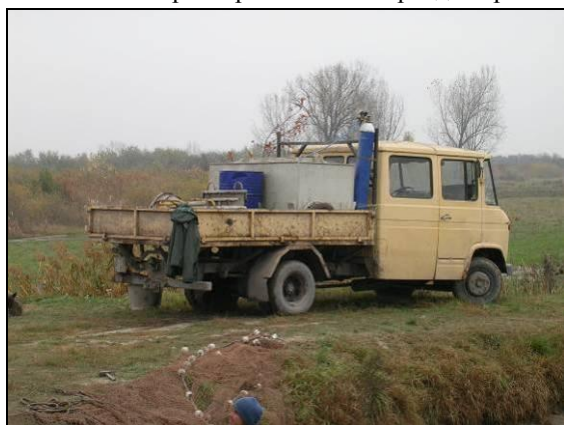
Грузовики, оборудованные для транспортировки рыбы в пределах хозяйства и между хозяйствами. Все устройства, как правило, оборудованы кислородными баллонами вне зависимости от того, как транспортируется рыба, внутри хозяйства или между хозяйствами.
