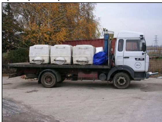
Грузовики, оборудованные для транспортировки рыбы в пределах хозяйства и между хозяйствами. Все устройства, как правило, оборудованы кислородными баллонами вне зависимости от того, как транспортируется рыба, внутри хозяйства или между хозяйствами.
