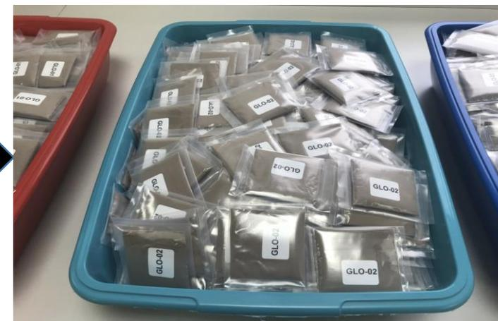
Les échantillons préparés doivent être conservés dans des récipients inertes et étanches et stockés dans un lieu de stockage approprié et bien ventilé
