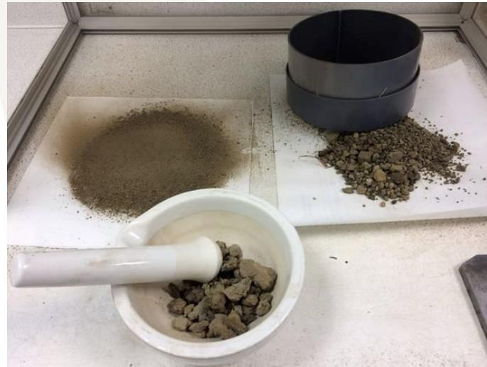
Les mottes sont délicatement écrasées et broyées à l'aide d'un pilon et d'un mortier en agate, puis tamisées à 2 mm
