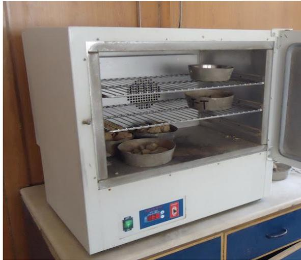
Séchage à l'air libre dans un endroit ventilé ou séchage à l'étuve (température légèrement supérieure à la ambiante ( $35 \pm 5 \text{ }^\circ\text{C}$ ))
