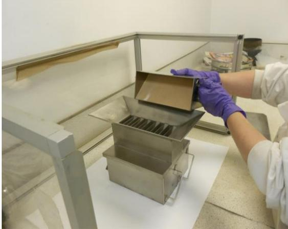
Le fractionnement en parties unitaires doit être effectué de manière à être représentatif tout en réduisant la variation entre les sous-échantillons
