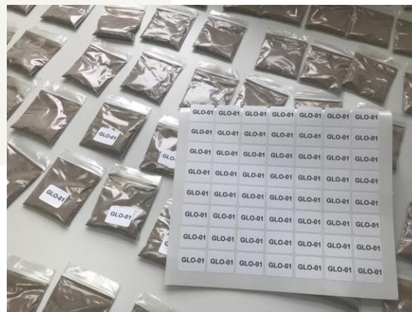
Les échantillons doivent être placés dans des sacs pour les protéger de l'humidité, des parasites, des pertes ou de la contamination
