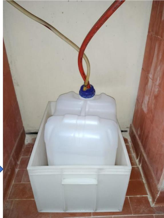
Recogida del residuo de Kjeldahl (Cu+NaOH)
