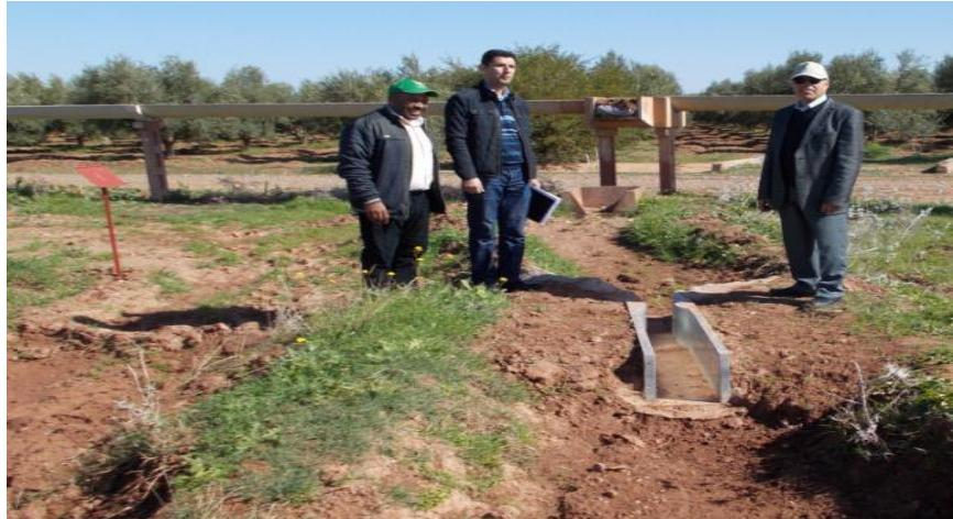
canal parshall de capacité 30l/s installé avant semi pour le contrôle des débits
