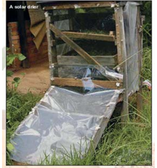
ছবি ২৪: সরাসরি সূর্যের আলোর সংস্পর্শ ছাড়াই সৌর শুষ্ককারী যন্ত্র ব্যবহার করে সূর্যের তাপে খাবার শুকানোর প্রক্রিয়া
