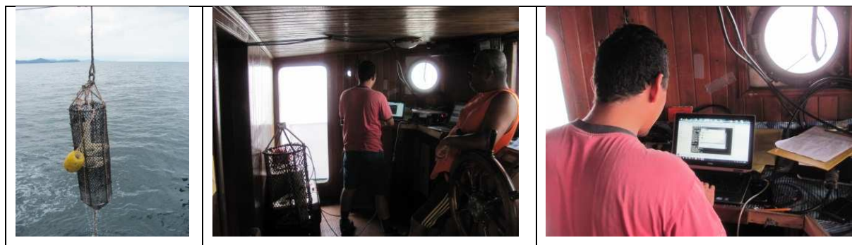
Figura 5. Toma de mediciones en estación oceanográfica, mediante la sonda multiparamétrica CTDO. Se evidencia la descarga y validación de información oceanográfica durante los cruceros de prospección.
