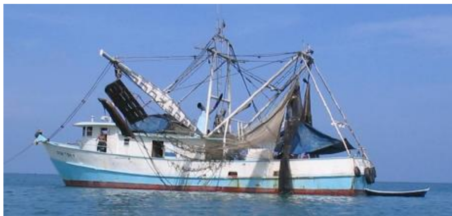
Figura 1. Embarcación camaronera “Don Tony” empleada en el experimento para evaluar la nueva tecnología de pesca, mostrando la puertas de arrastre tradicionales.
