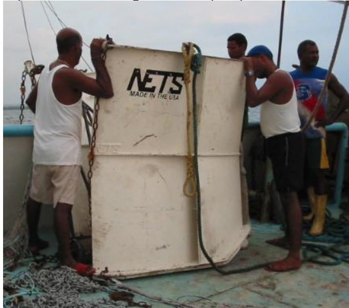
Figura 11. Reconocimiento e instalación de la puerta de arrastre innovada empleada por la embarcación con la tecnología innovada en los experimentos
