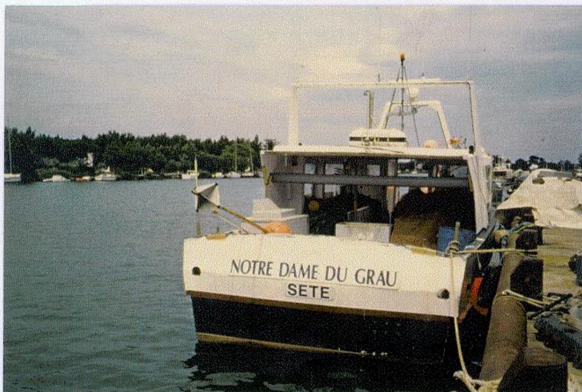
Photo 2 - Fileyeur à filets maillants dérivants («thonnailles») «Notre Dame Du Grau »- Le Grau d'Agde. (14,1m/16,9tjb/235kw/1976).
