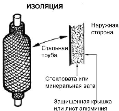
Рис. 2.1 – Система «сухого» выхлопа. Чертежи и примечания
