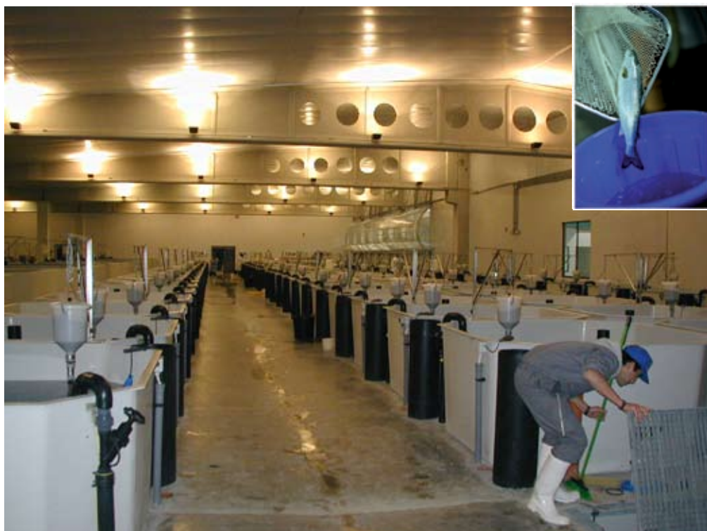
Иллюстрация 8.1 УЗВ для выращивания смолта в Чили. Источник: Бент Хейгор
