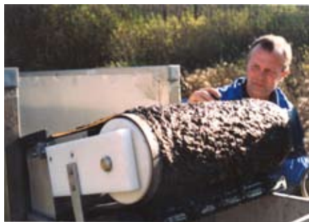
Иллюстрация 6.2 Ленточный фильтр «Hydrotech», используемый для обезвоживания шлама. Источник: Hydrotech
