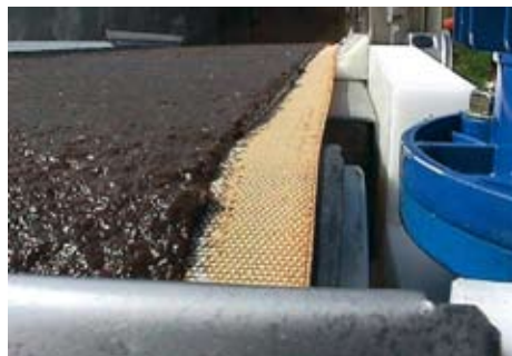
Иллюстрация 6.2 Ленточный фильтр «Hydrotech», используемый для обезвоживания шлама. Источник: Hydrotech
