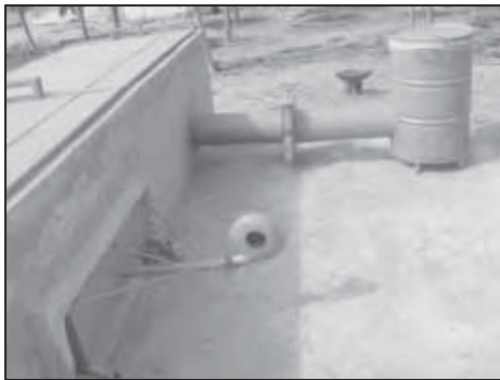
Photo 1 et Figure 1. Vue générale du fumoir indirect (four parpaing du CNFTP A réfectionné connecté au générateur de fumée)
