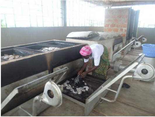
Photo 1 : Opération de fumage de poisson au four moderne
