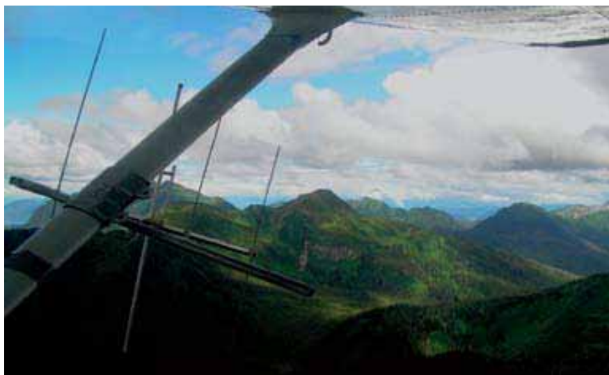
FIGURE 7.8 Antenne Yagi à quatre éléments fixé sur le hauban de voilure d'aéronef
