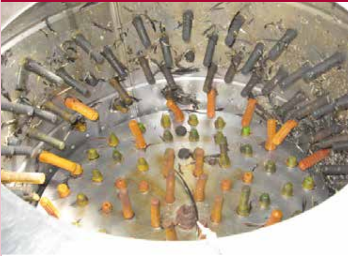
Los dedos mecánicos deben sustituirse periódicamente, ya que los dedos rotos y desgastados pueden contener bacterias.
