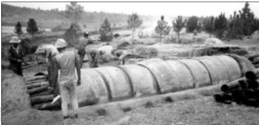
Ce four en métal du type "Subri-fosse" semi-permanent et bon marché à Madagascar a été conçu pour carboniser les chutes provenant des scieries
